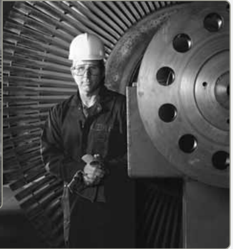
▲ Este inspector examina una sección de turbina a baja presión. Las puntas de esta turbina de aspas giran a velocidades supersónicas de 1,300 millas por hora cuando las plantas están en operación. Una fractura en una de las aspas puede causar fallas catastróficas.
