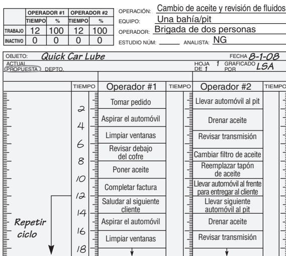
▲ Figura 10.6 Gráfica de actividad para una brigada de dos personas que realiza un cambio de aceite en 12 minutos en Quick Car Lube
